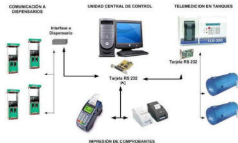
Imagen III. 55. Controles Volumétricos en Estaciones de Servicio.
