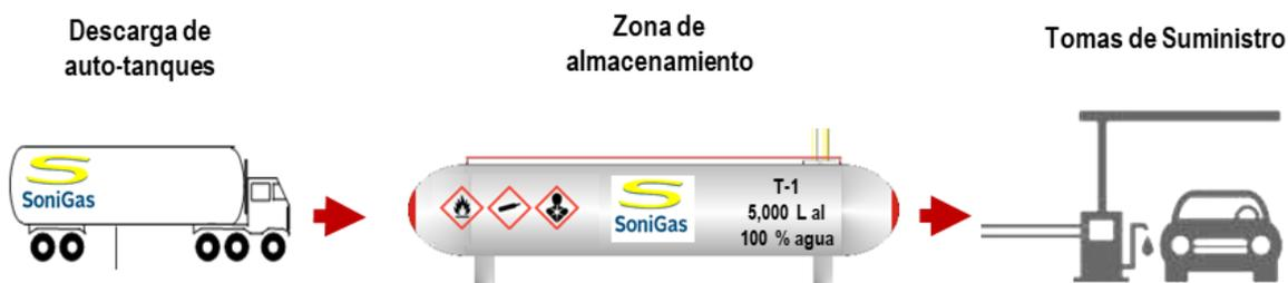
**Figura III.3.** Proceso de operación de la Estación de gas L.P. para carburación, San Cristóbal.
