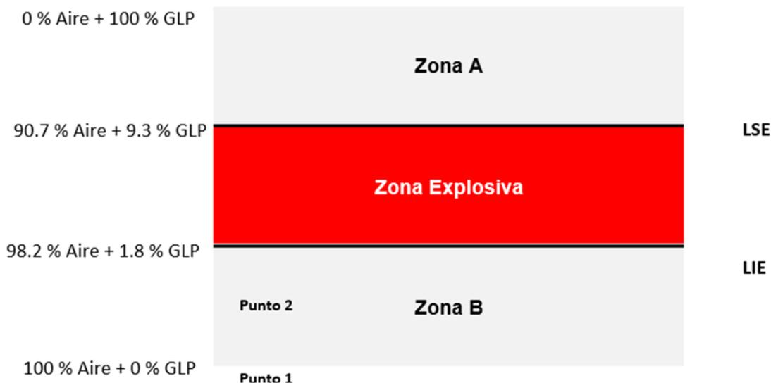
**Punto 1** = 20 % del LIE: Valor de ajuste de las alarmas en los detectores de mezclas explosivas.
