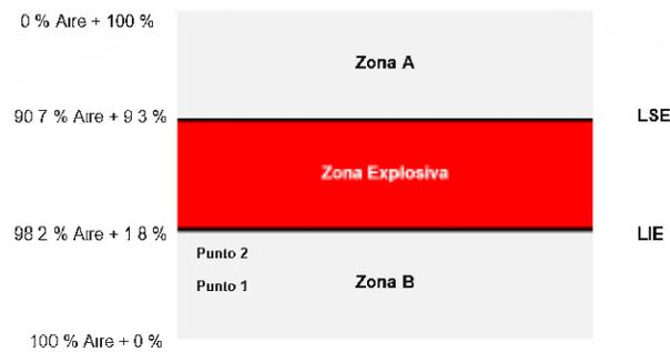
**Punto 1** = 20 % del LIE: Valor de ajuste de las alarmas en los detectores de mezclas explosivas.
