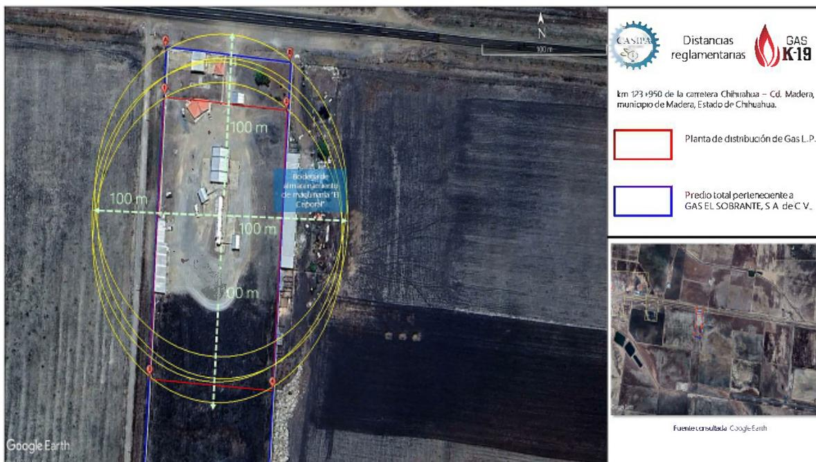
**Figura II. 2:** Distancia mínima externa equivalente a 100 m desde la tangente del recipiente del almacenamiento.
