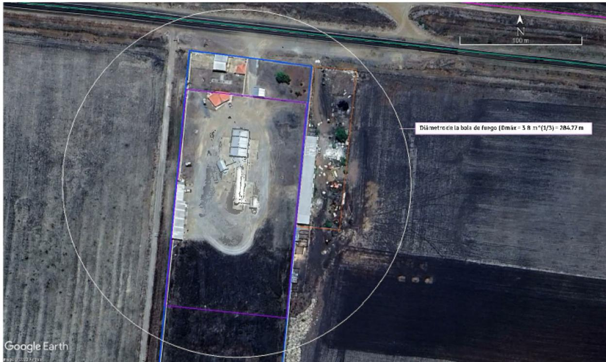
**Figura VII. 2:** Máximo diámetro de la bola de fuego originada por la Bleva del recipiente
