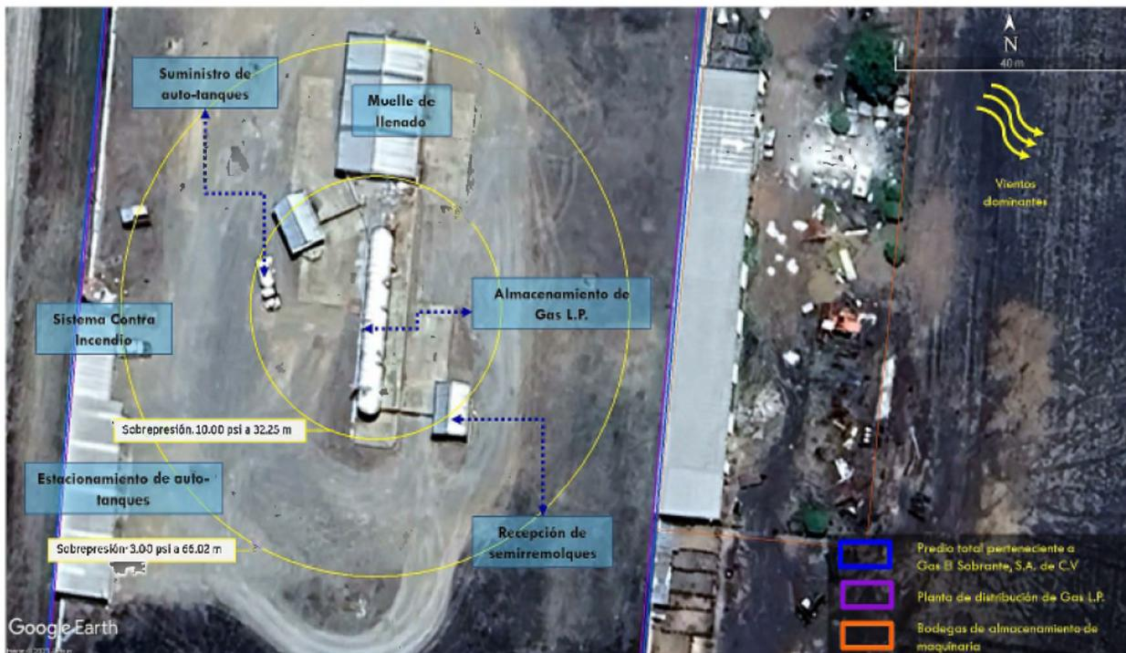
**Figura VII. 5:** Zona de alto riesgo por daño a equipo a la onda de sobrepresión causada por la explosión de los recipientes de almacenamiento de la planta
