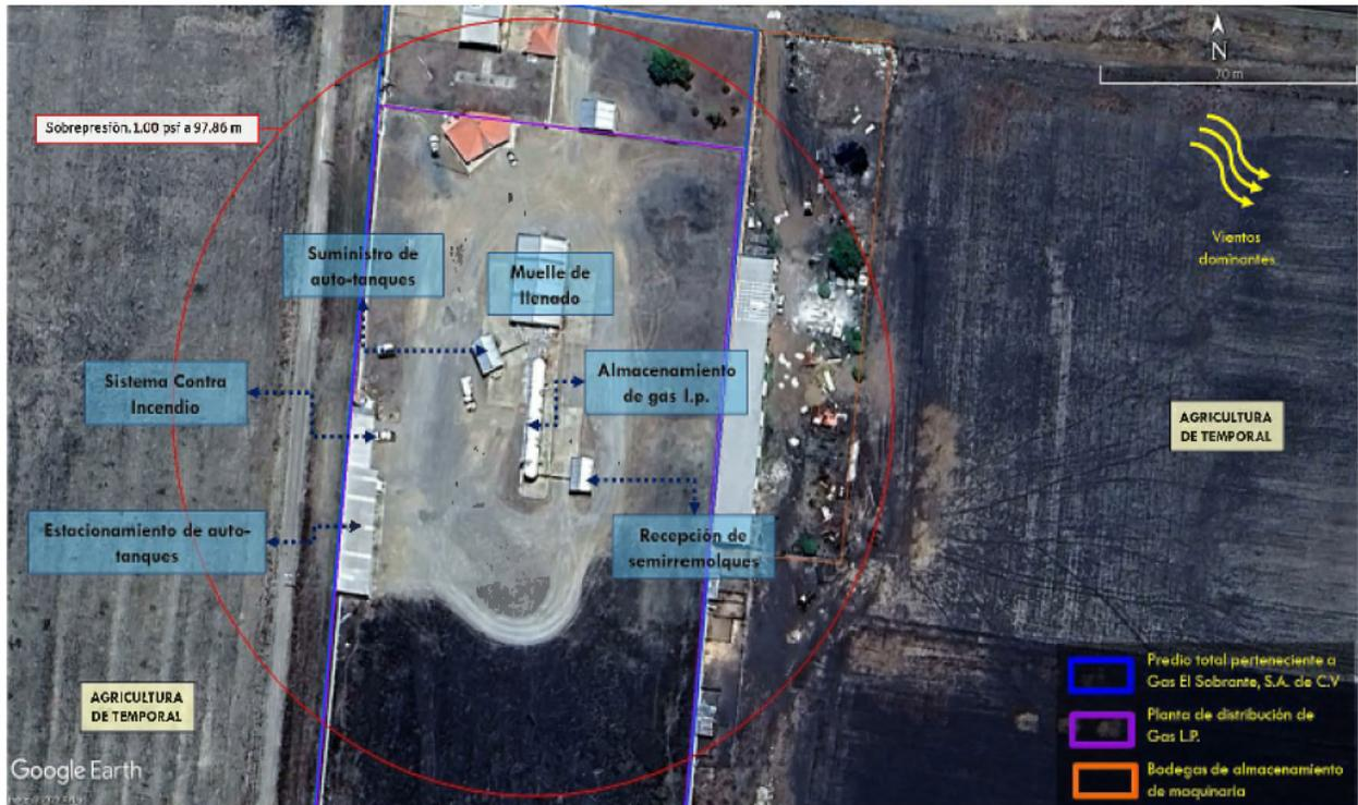
Figura VII. 6: Zona de Alto Riesgo por onda de sobrepresión causada por la explosión de los recipientes de almacenamiento
