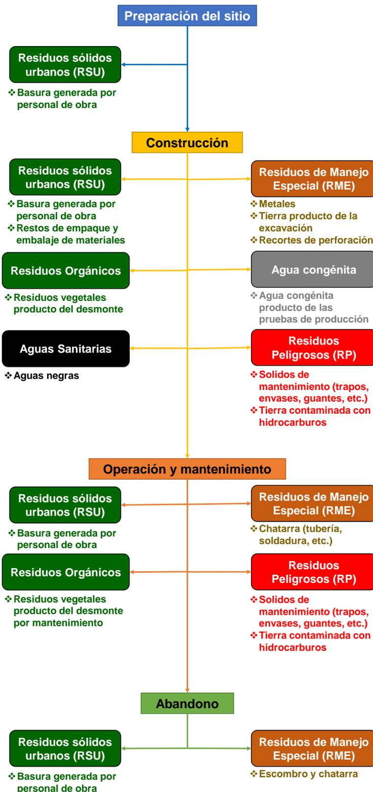
Figura 45 Diagrama de flujo de los Residuos Generados en cada una de las etapas.
