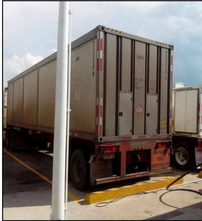
**Figura 18. Semirremolque industrial para el transporte de Gas Natural Comprimido.**
