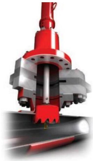
Figura I.7.- Arreglo básico del accesorio soldado al ducto de transporte, válvula tipo “sándwich y herramienta de perforación, durante la operación de Hot-Tapping.
