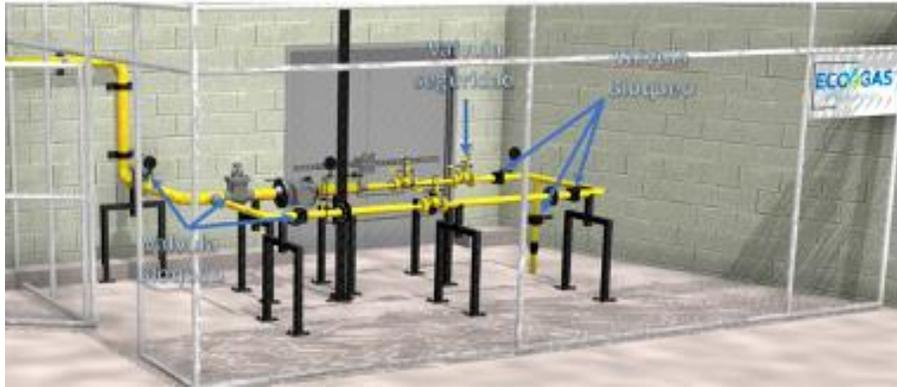
**Figura 10 Ejemplo de instalación con válvulas de bloqueo.**
