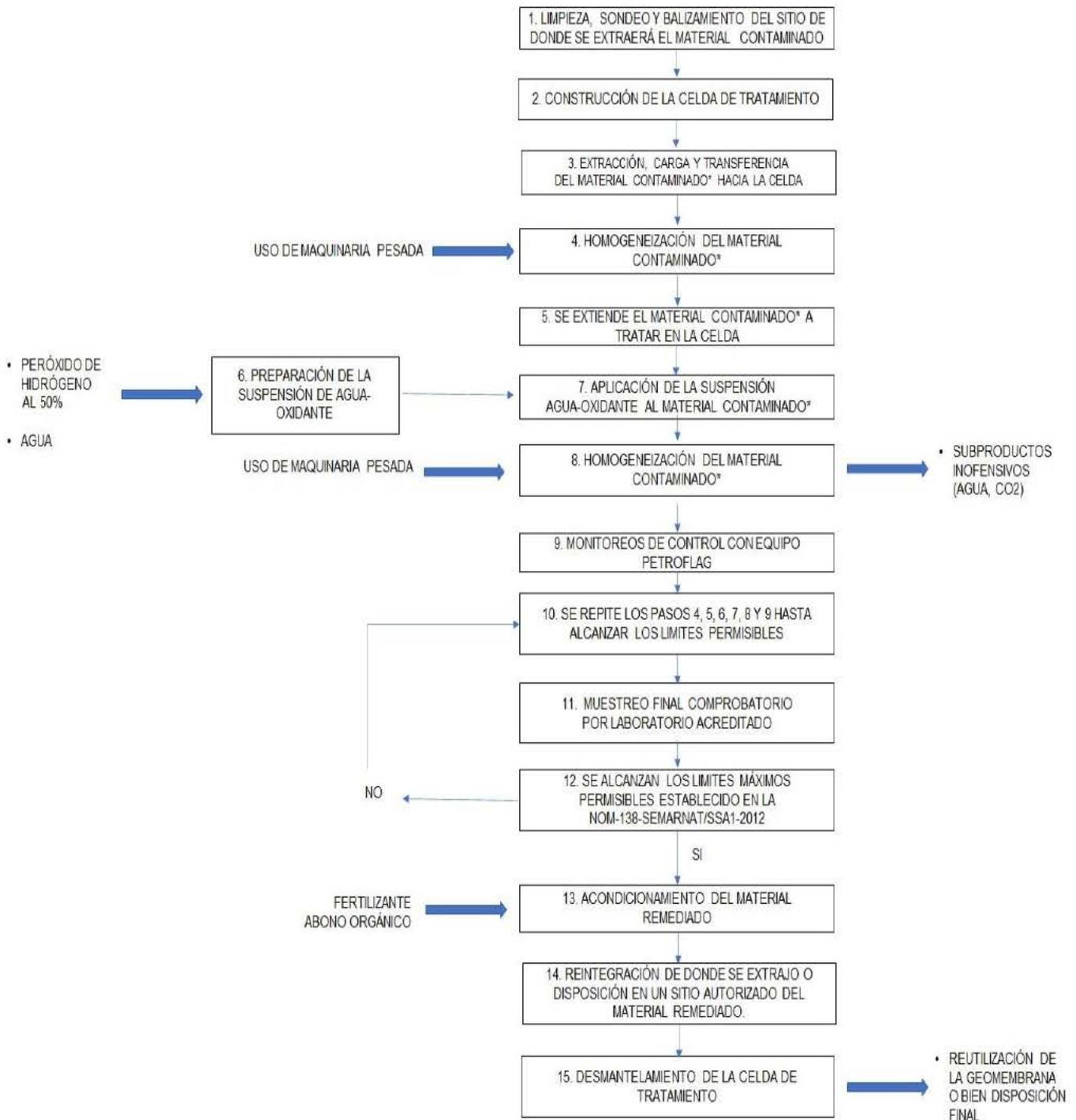
\* El material a tratar suelo contaminado con hidrocarburos de fracción media y pesada
