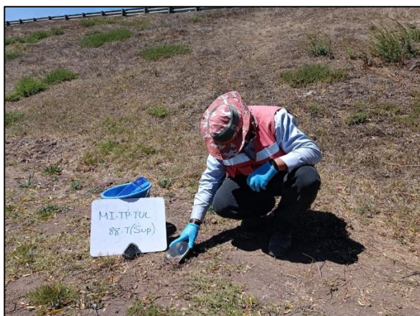
23.- Se realizó la toma de la muestra Testigo con apoyo de un cucharón de acero inoxidable.
