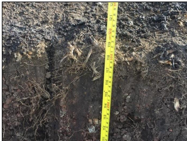
05.- Con apoyo de un flexómetro se verificó la profundidad de los puntos de sondeo.
