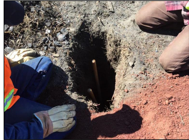
04.- Los sondeos se realizaron a diferentes profundidades, con el fin de conocer la infiltración de la sustancia en el suelo natural.
