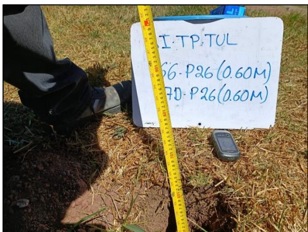
17.- Las profundidades de los puntos de muestreo fueron verificadas con apoyo de flexómetro.
