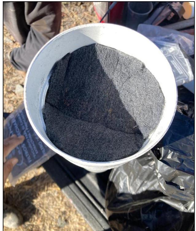
5. Preparación de los tubos de carbón activado, a los cuales se le colocó una malla y carbón activado.
