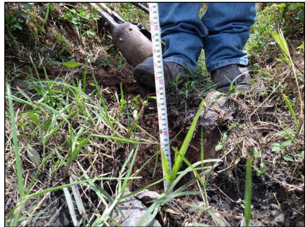
14. Se registraron y verificaron las profundidades de los puntos de muestreo con ayuda de un flexómetro.
