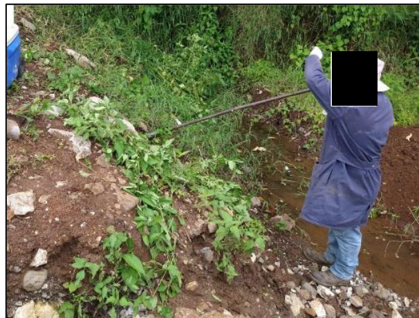
10. Con apoyo del Hand Auger, se tomaron muestras en la Periferia de las Fosas de Excavación.
