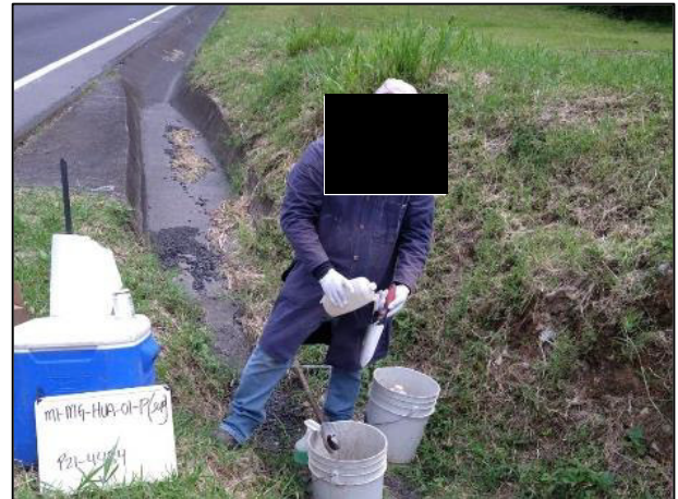
02. El equipo utilizado para la toma de muestras se lavó con jabón libre de fosfatos y agua destilada al inicio del muestreo.
