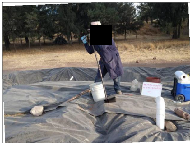
15. Con apoyo de un Hand Auger de acero inoxidable se realizó la toma de muestra dentro de la Celda Provisional.
