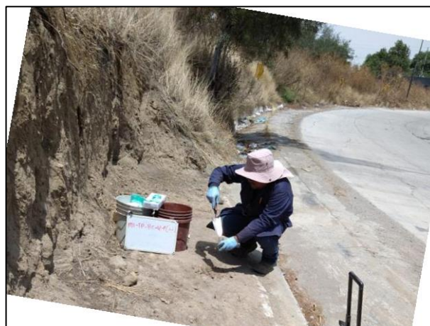
4. Toma de muestra en el fondo de la Zona de Excavación.
