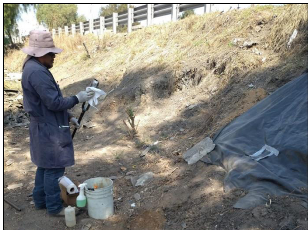
13. El personal encargado de la toma de muestras lavó el equipo utilizado con jabón libre de fosfatos entre cada toma de muestras.
