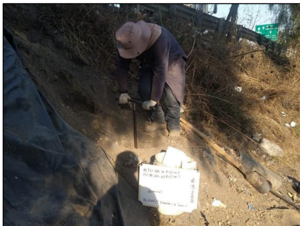
09. Con apoyo del Hand Auger de acero inoxidable se realizó la toma de muestras en la Periferia del Área Afectada "B".
