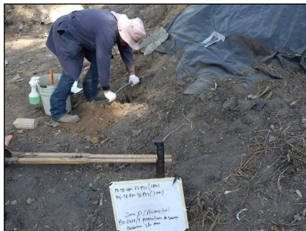
14. Con apoyo del Hand Auger de acero inoxidable se realizó la toma de muestras en la Periferia del Área Afectada "D".
