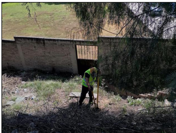
05. Se realizaron sondeos en las periferias de las Áreas Afectadas con el apoyo de pocera. Con apoyo de GPS se realizó el levantamiento de coordenadas en el sitio.
