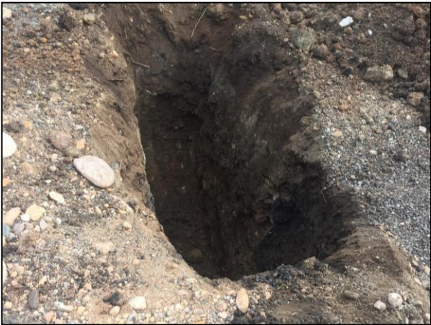
9. Realización de pozos de sondeo, con la finalidad de conocer la pluma contaminante del hidrocarburo.
