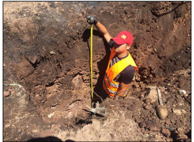
10. Para conocer la pluma del contaminante Diésel en el suelo natural, se utilizó una cinta métrica.
