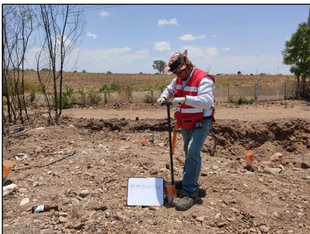
5. Se realizó la toma de muestras de acuerdo con el Plan de Muestreo. Toma de muestra en el fondo de la Zona de Excavación (Zona A).
