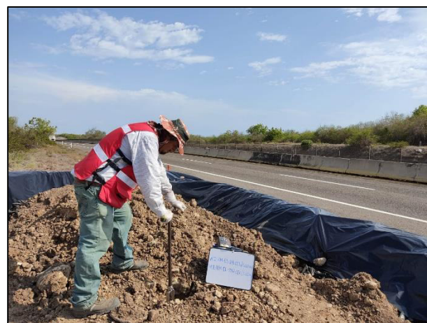
10. Con apoyo del Hand Auger se realizó la toma de muestra dentro de la Celda Provisional.
