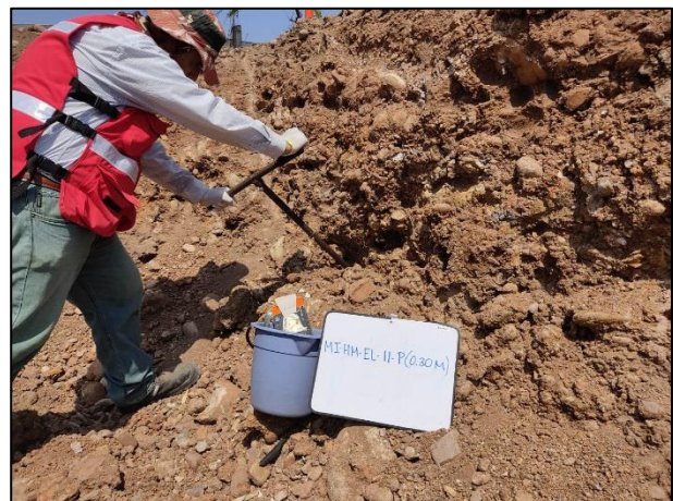
6. Se utilizó Hand Auger de acero inoxidable para la toma de muestras. Toma de muestra en la pared de la Zona de Excavación (Zona B).
