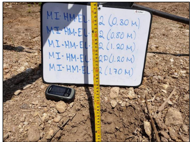
4. La profundidad de cada punto de muestreo fue verificada con ayuda de un flexómetro.
