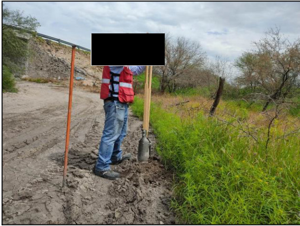
05. Con apoyo de una pocera, se realizaron sondeos en distintos puntos de la Zona Afectada.
