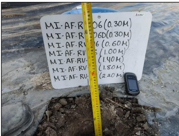
06. Las profundidades de los puntos de muestreo fueron verificadas con apoyo de flexómetro.
