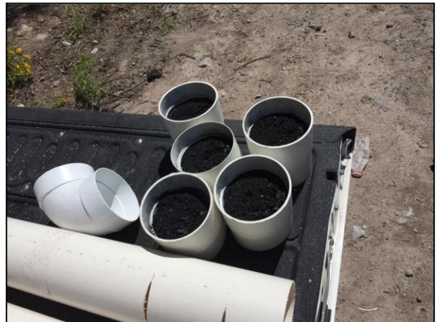
04. Se acondicionaron los filtros de carbón activado para ser colocados sobre suelo contaminado en las Zonas Afectadas.
