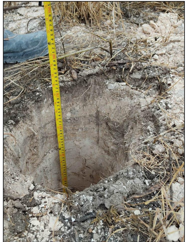
04. Con apoyo de flexómetro se corroboró la infiltración del hidrocarburo.
