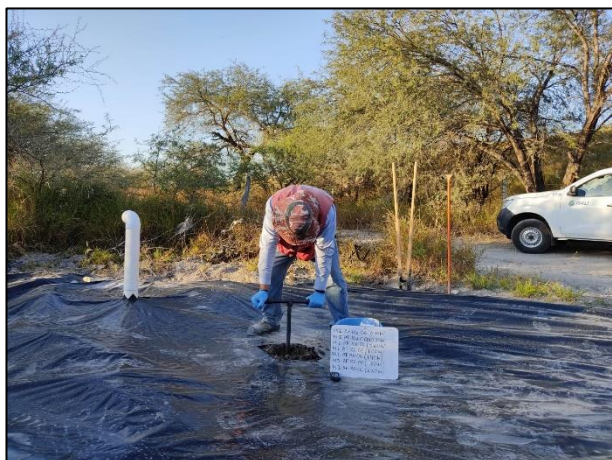
07. Se llevó a cabo la toma de muestras a diferentes profundidades con apoyo del Hand Auger.
