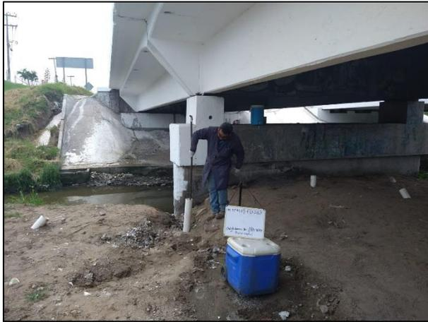
1. De acuerdo con la pizarra y el plan de muestreo inicial, en esta imagen se puede apreciar la toma de muestra del punto 9, correspondiente al fondo de la Fosa de Excavación.
