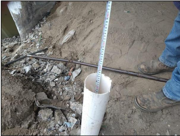
3. Se verificó la profundidad con apoyo de la cinta métrica, por lo que considerando los 2.00 m de profundidad de la Fosa de Excavación + los 0.20 m a la cual se debía tomar la muestra, tenemos un total de 2.20 m, lo cual fue corroborado con la cinta métrica.
