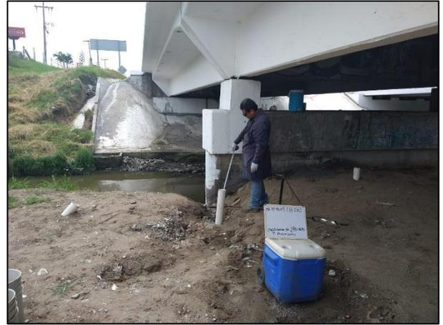
2. Se puede apreciar que el muestreador verificó la profundidad del tubo, a fin de asegurar la profundidad de la muestra a tomar.
