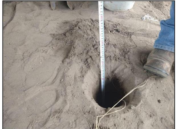
13. Se verificó la profundidad para la posterior toma de muestras de periferia, esto con apoyo de la cinta métrica, por lo que se puede observar los 2.00 m de profundidad.
