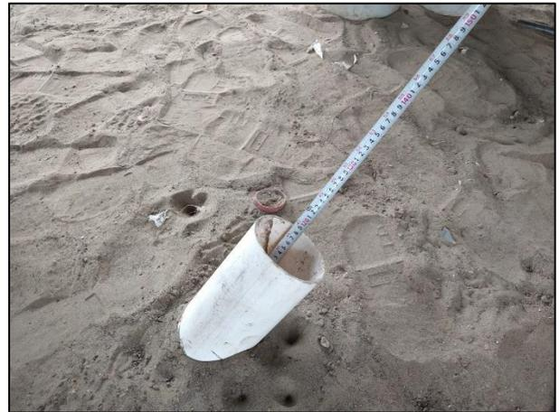
4. Se realizó la medición de las profundidades con un flexómetro en los puntos de muestreo de acuerdo con el plan de muestreo inicial.
