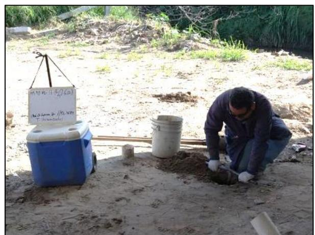
12. Se realizó la toma de muestra en el material usado para relleno de la Fosa de Excavación.
