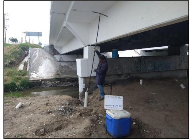
4. Verificada la profundidad necesaria, se procedió a la toma de muestras con apoyo del Hand Auger. En la imagen se observa que fue necesario utilizar extensiones del Hand Auger.
