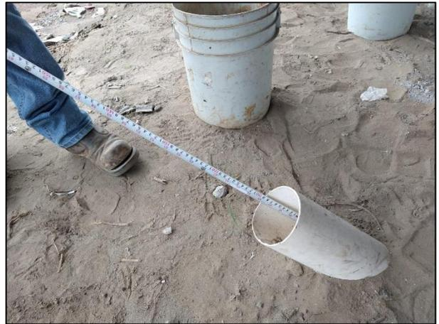
7. Se verificó la profundidad para la posterior toma de muestras del punto 5 correspondiente a la pared de la Fosa de Excavación, esto con apoyo de la cinta métrica.
