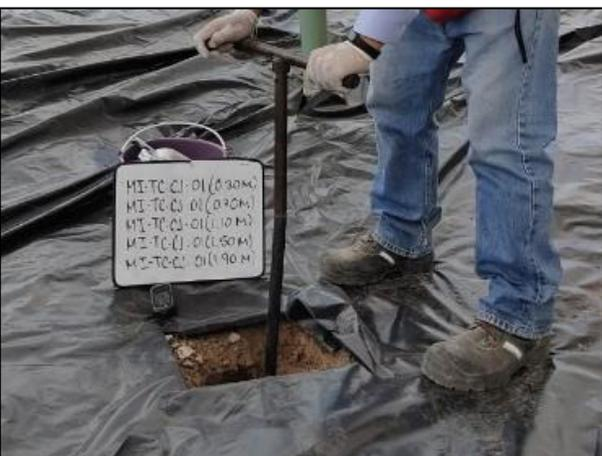
05 - Se realizó el muestreo a diferentes profundidades en la Zona afectada, con apoyo del Hand Auger.
