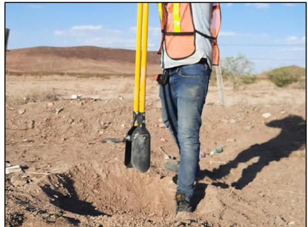
06 - Realización de sondeos en el sitio con el fin de conocer la infiltración de la sustancia en el suelo natural.
