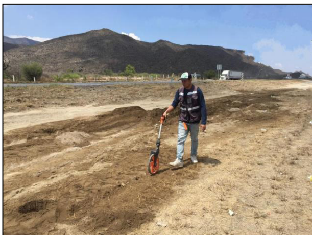
07. Con apoyo del odómetro se midieron las dimensiones del área afectada .
