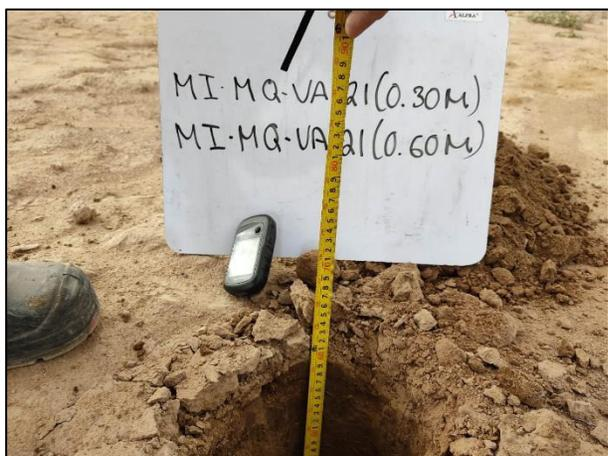
17. Verificación de la profundidad del punto de muestreo 21, correspondiente a la periferia de la Zona de Excavación.
