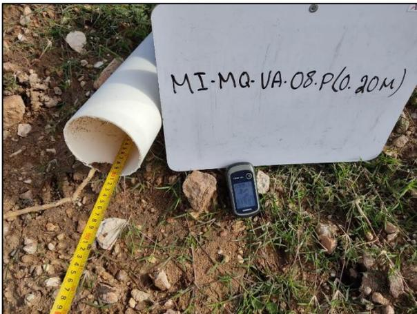
9. Se verificó la profundidad para la posterior toma de muestras del punto 8 correspondiente a la pared de la Zona de Excavación, esto con apoyo de la cinta métrica.
