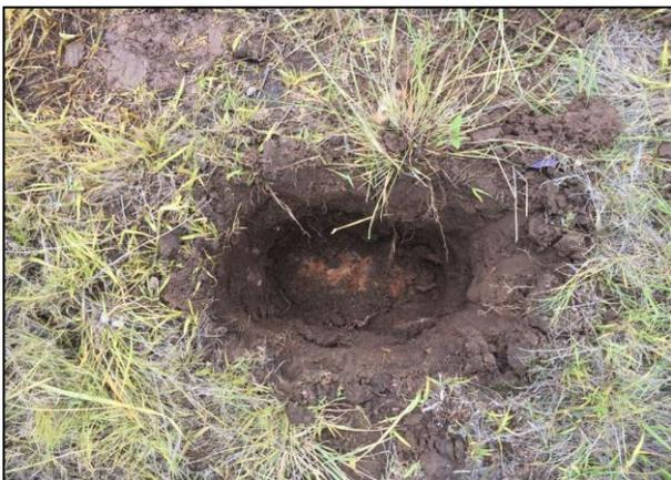
5. Se realizaron sondeos en el suelo afectado, encontrando a 0.60 m de profundidad, una base rocosa.
