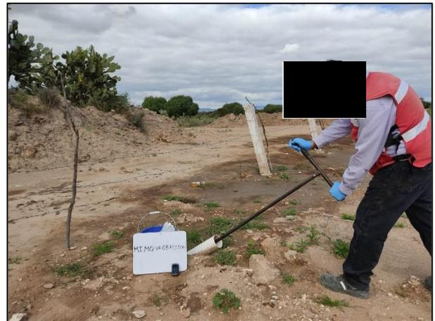
8. Toma de muestra con apoyo de Hand Auger de acero inoxidable.
