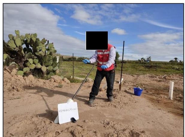
12. Toma de muestra con apoyo de Hand Auger de acero inoxidable.
