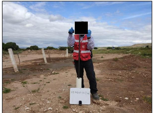
2. Se puede apreciar que el muestreador procedió a la toma de la muestra en el fondo de la Zona de Excavación, con apoyo de los tubos de monitoreo.
