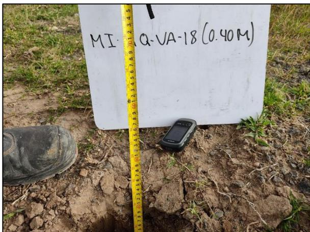
13. Con apoyo de una cinta métrica, se verificó la profundidad de la toma de muestras a 0.40 m.
