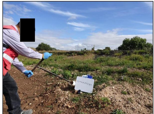
10. Se procedió a la toma de muestras en la pared de la Zona de Excavación, esto con apoyo de los tubos de monitoreo, colocados en las Labores de Extracción.
