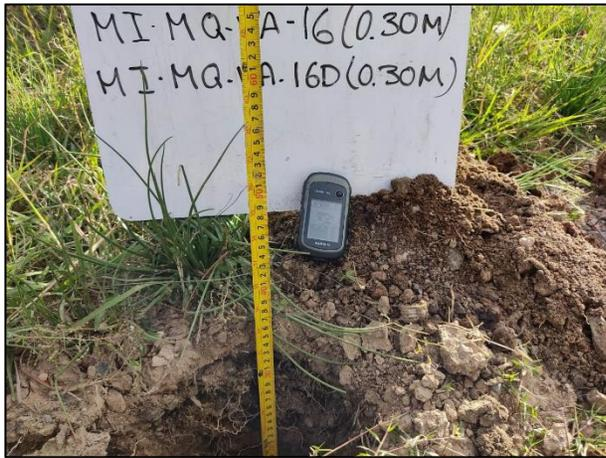
7. Se realizó la medición de las profundidades en los puntos de muestreo de acuerdo con el plan de muestreo.
