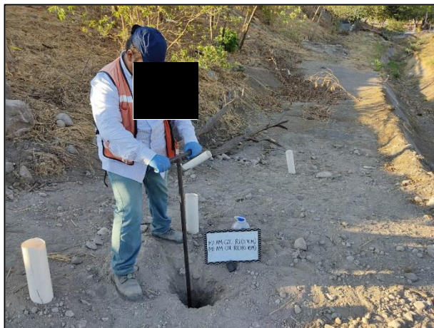
09. Con apoyo de un Hand Auger de acero inoxidable se realizó la toma de muestra en el material edáfico libre de contaminantes utilizado como relleno.
