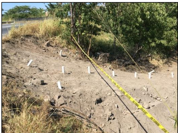
17. Tubos de muestreo colocados en la Fosa de Excavación (Área I), misma que fue rellena.
