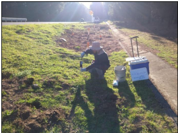
07 - Con apoyo de cucharón de acero inoxidable se realizó la toma de muestras superficiales. Toma de muestra superficial en periferia de la Zona de Extracción D.
