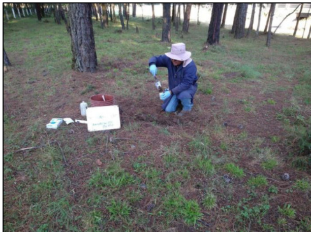
13 - Se realizó la toma de la muestra testigo con apoyo del cucharón de acero inoxidable.
