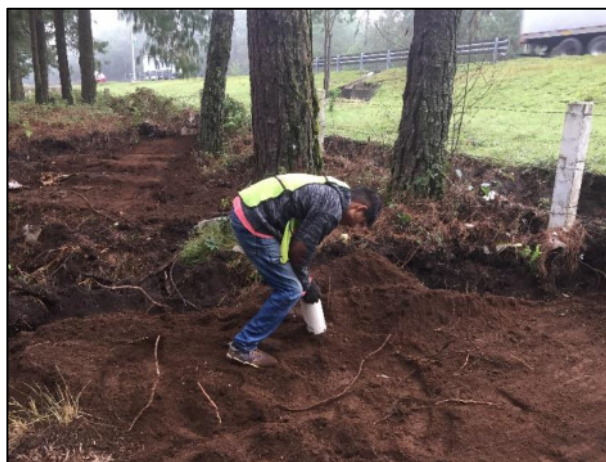
22 - Paralelamente al relleno de la Fosa de Excavación B, se realizó la instalación de tubos PVC dentro de esta Fosa con la finalidad de poder tomar las muestras de suelo durante el Muestreo Inicial.
