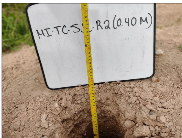
11. Las profundidades de los puntos de muestreo fueron verificadas con apoyo de flexómetro.
