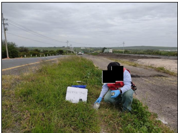
17. Con apoyo del cucharón de acero inoxidable se realizó la toma de la muestra testigo fuera del Área Afectada.
