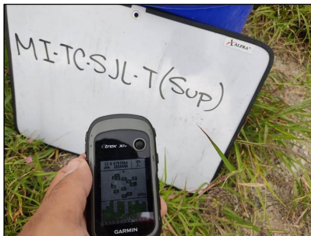
16. Se utilizó GPS para determinar la ubicación de los puntos de muestreo.
