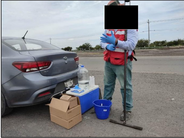
1. Para la toma de muestras se utilizaron guantes al inicio y entre cada toma, para evitar la contaminación cruzada de las mismas.
