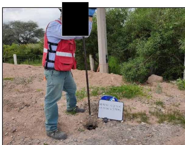
10. Con apoyo de un Hand Auger de acero inoxidable se realizó la toma de muestras en la periferia de la Fosa de Excavación.
