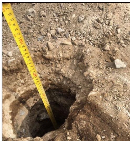
6. Para conocer la migración del contaminante, con apoyo de una cinta métrica se tomaron las profundidades hasta la cual llegó la pluma.
