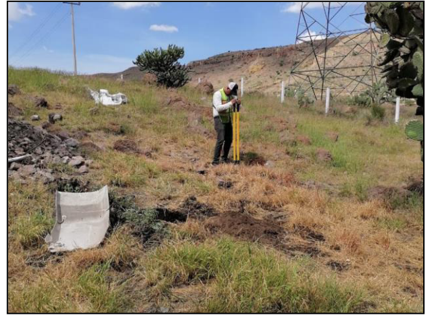
6. Personal de campo procedió a ejecutar los sondeos en campo, esto con apoyo de una pocera.
