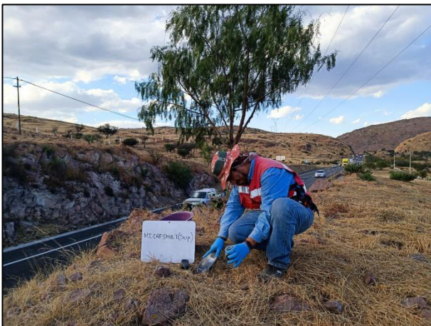
17. Con apoyo del cucharón de acero inoxidable se realizó la toma de la muestra testigo superficial fuera del área afectada.
