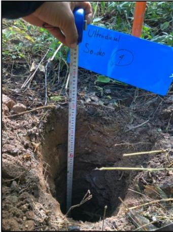
07. Con ayuda de flexómetro se corroboraron las infiltraciones en el suelo afectado con Diésel.
