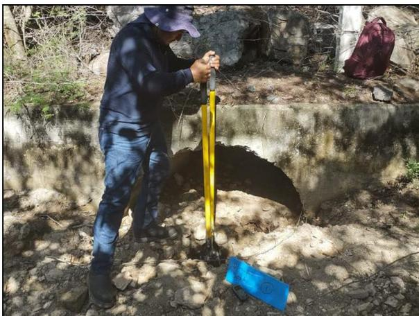
11. Con el apoyo de pocera se realizaron sondeos dentro del Área Afectada (Fosa de Excavación "B").
