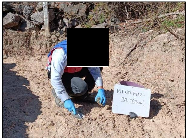
12. Toma de muestra en el fondo de la Fosa de Excavación "B", con apoyo de un cucharón de acero inoxidable.
