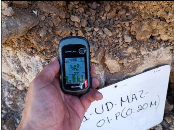
03. Los puntos de muestreo fueron identificados de acuerdo con el plan de muestreo inicial y con apoyo de una pizarra y GPS.
