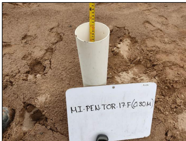
06. Se realizó la medición de las profundidades con un flexómetro en los puntos de muestreo de acuerdo con el plan de muestreo inicial.
