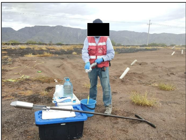
15. El personal encargado de la toma de muestras limpió el equipo utilizado entre cada toma de muestras, para evitar contaminación cruzada.
