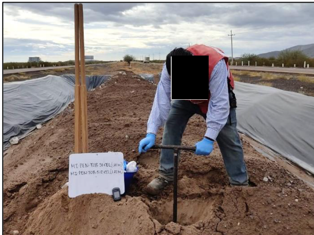
13. Con apoyo del Hand Auger, realizó el muestreo dentro de la Celda Provisional.
