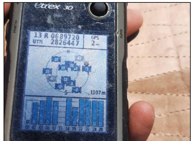
06. Con apoyo de GPS se realizó el levantamiento de coordenadas en el sitio.
