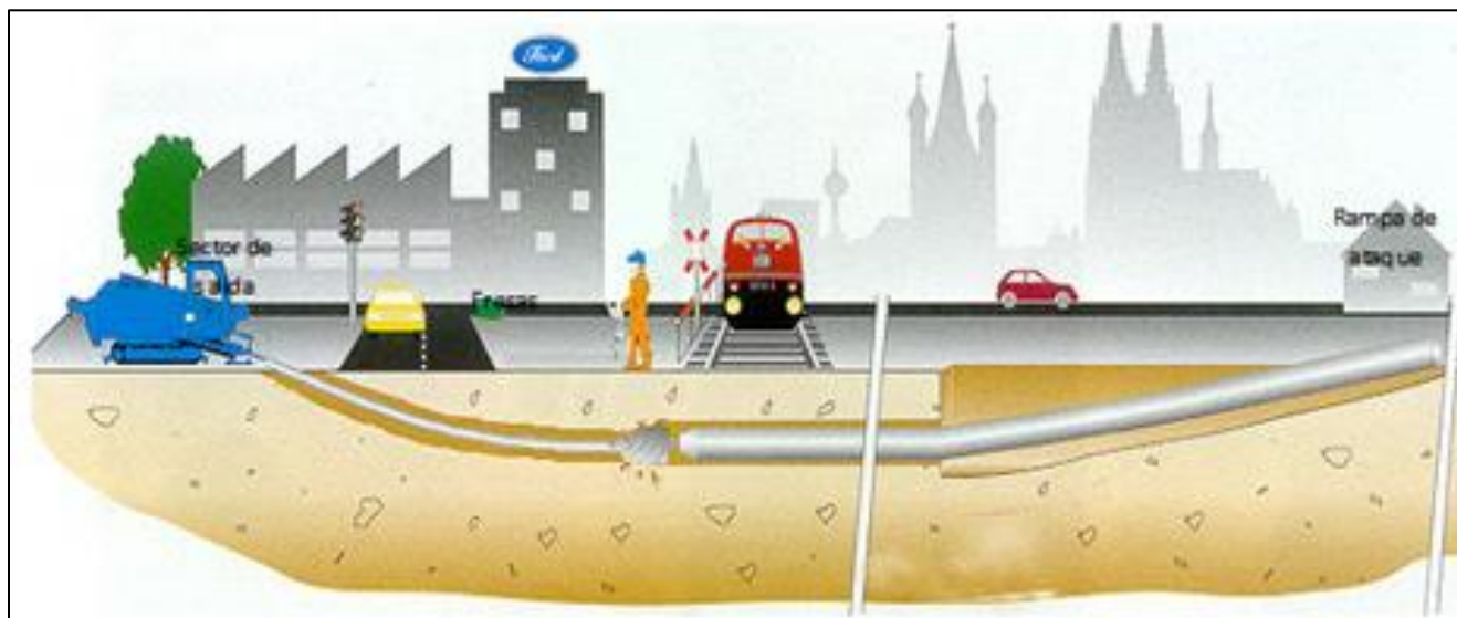
Fig. 42. Técnica de perforación direccional.
