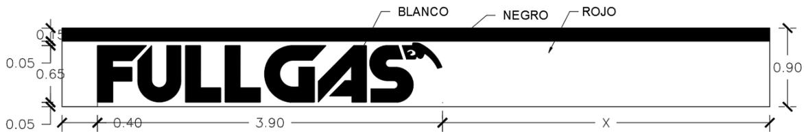
Fig. II. 9 Diseño de faldón.
