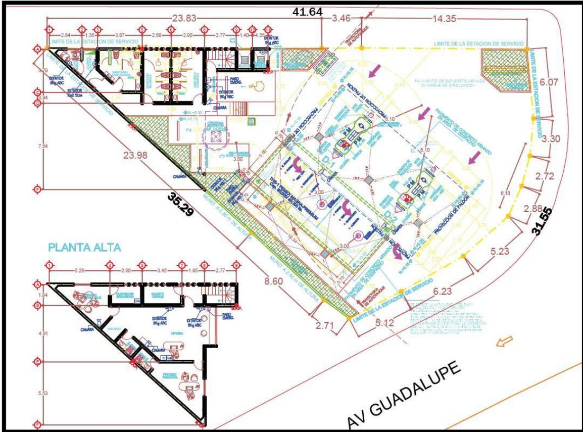
Imagen 12. Plano de Conjunto de ESTACION DE SERVICIO, "GASOLINERA CHAPALITA S.A. DE C.V."
