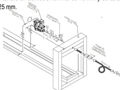
Imagen. Toma de suministro de la Estación de Gas L.P. para Carburación.
