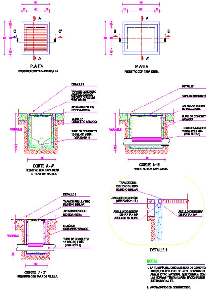
Figura III. 7.- Detalle típico para instalación de drenaje.
