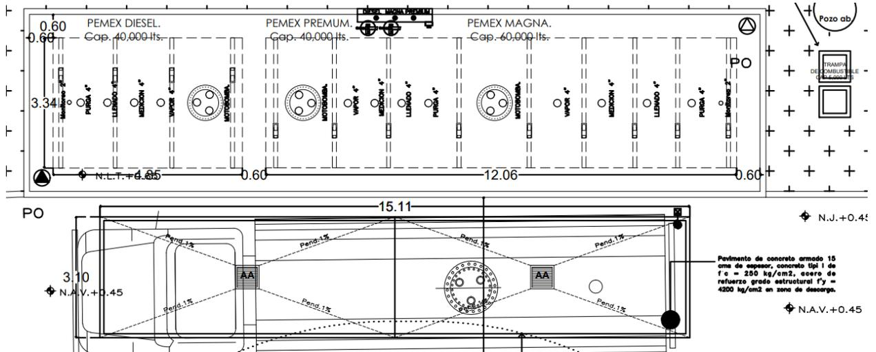
**Figura III. 1.-** Distribución de los tanques de almacenamiento (proyecto).
