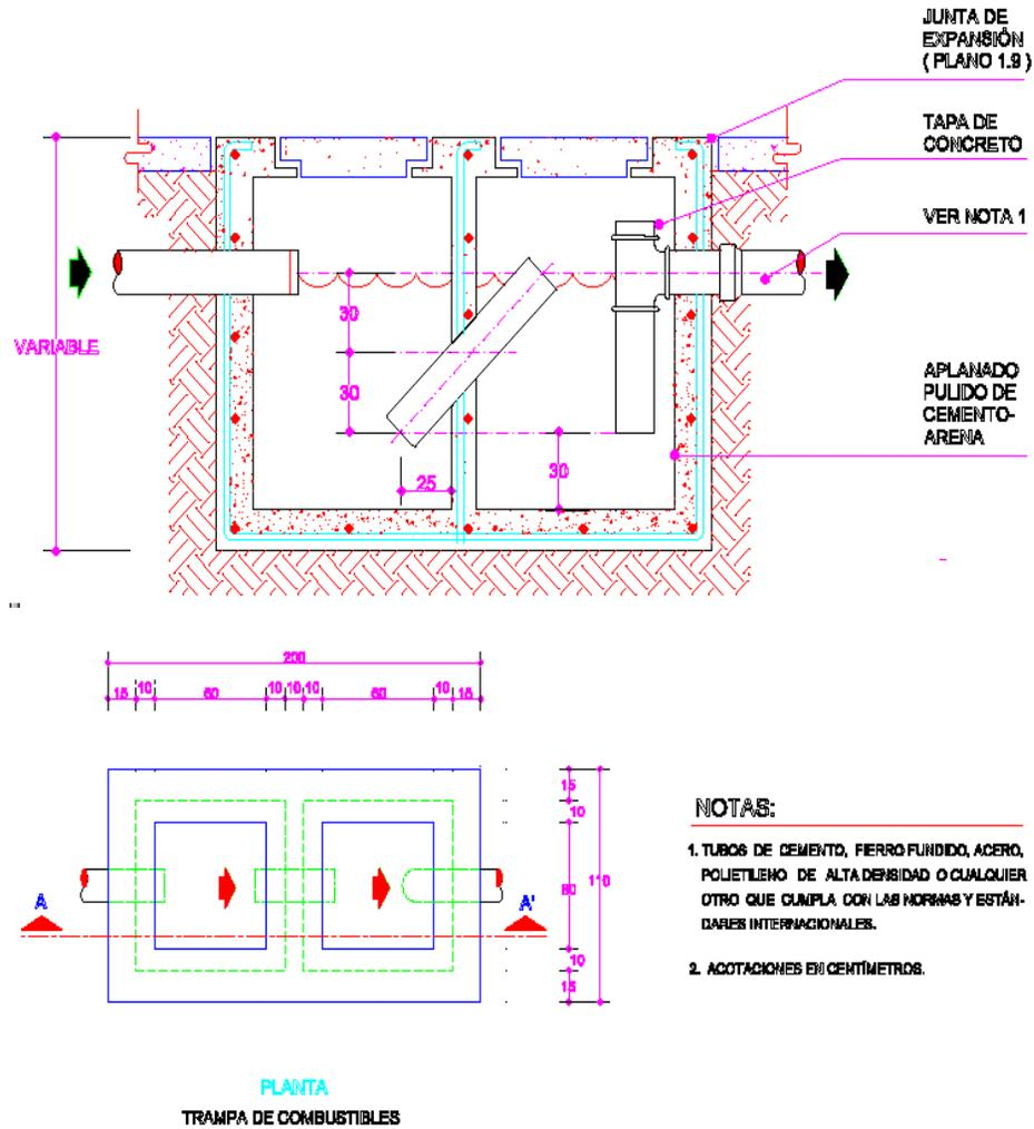
**Figura III. 8.-** Trampa de combustibles.
