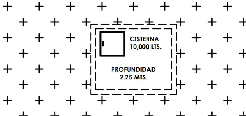
**Figura III. 6.-** Cisterna para almacenamiento de agua potable, fuente: Plano arquitectónico de conjunto (Anexo “6.1.”)
