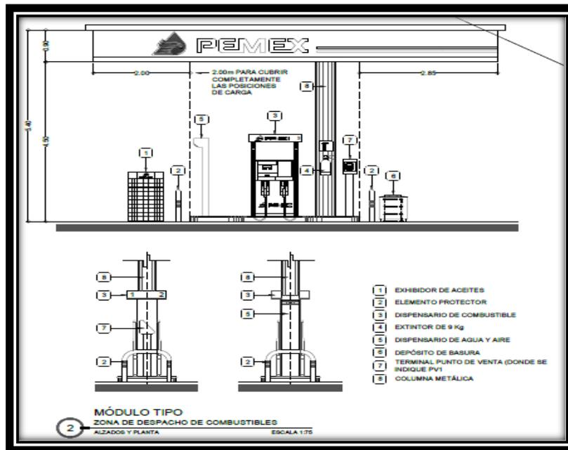
Imagen 11. Diagrama Tipo del Módulo de Abastecimiento.
