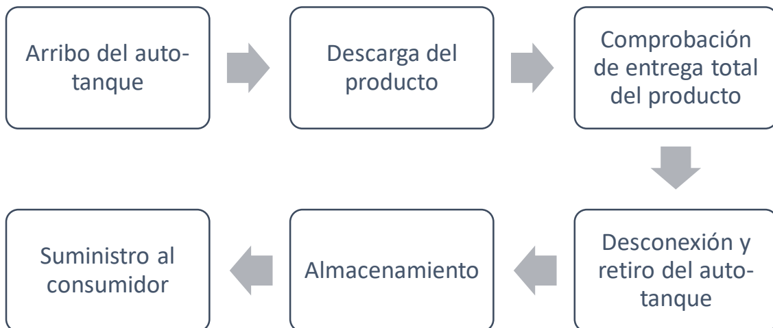
Ilustración 8. Proceso de operación general del proyecto
