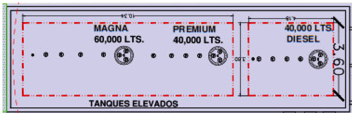
Figura 14.- Distribución general de tanques de almacenamiento.
