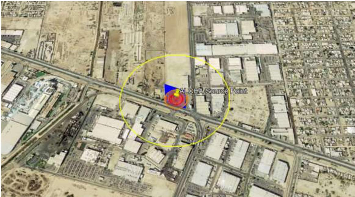
IMAGEN 15. Escenario de riesgo por incendio en las actividades de descarga de un auto-tanque, al tanque de almacenamiento de Diésel. Aloha.
