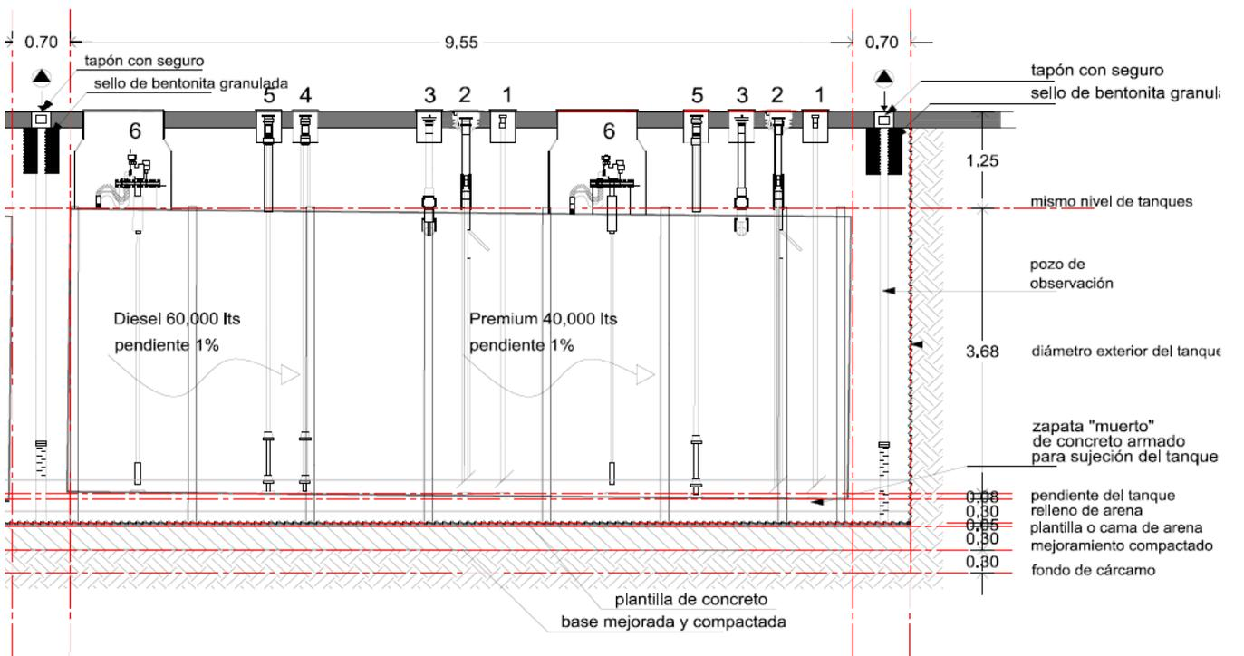
Figura 9: Accesorios con los que contarán los tanques de Almacenamiento.
