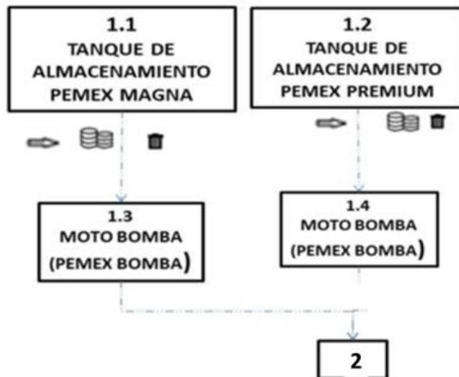
Figura 14. Diagrama de funcionamiento de almacenamiento de combustible.
