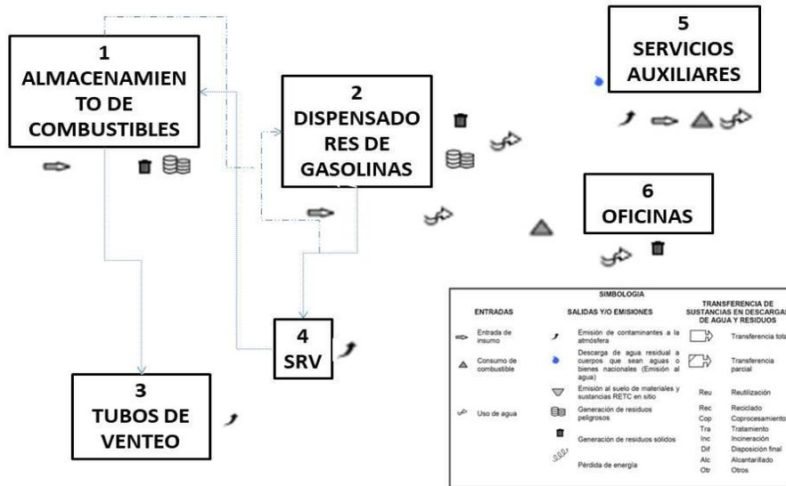
Figura 13. Diagrama de funcionamiento general para la Estación de Servicio.
