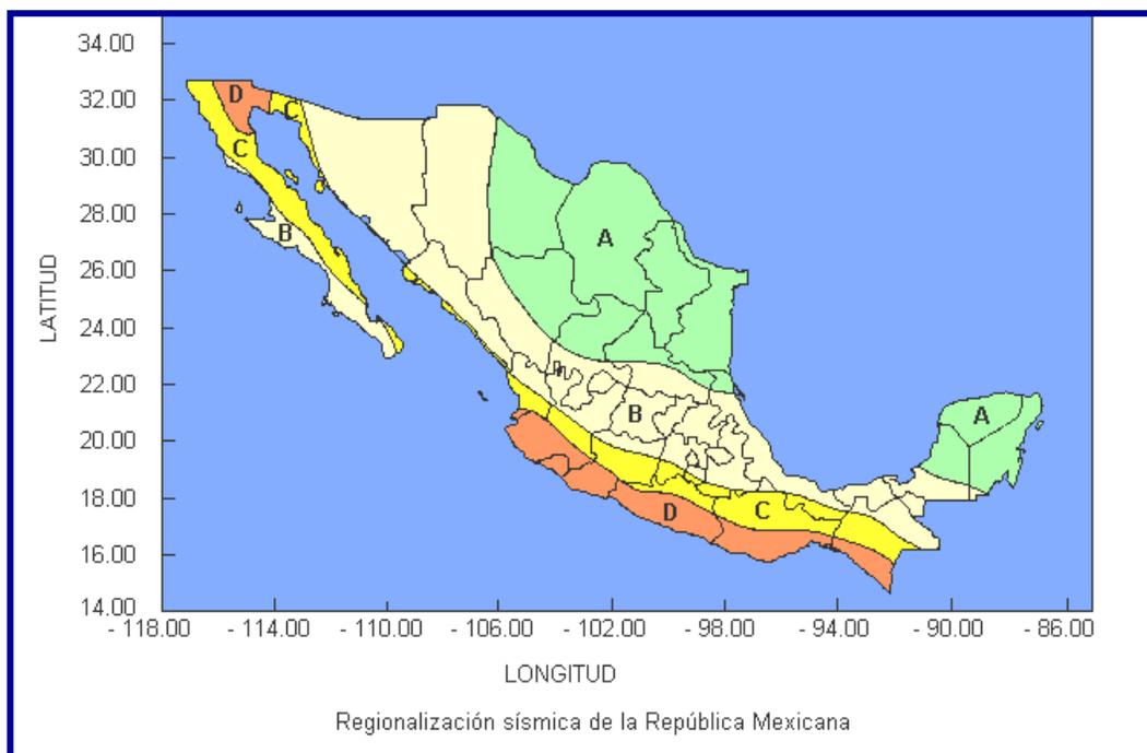
Imagen 12. Fuente: Manual de diseño de Obras Civiles (Diseño por Sismo) de la Comisión Federal de Electricidad.
