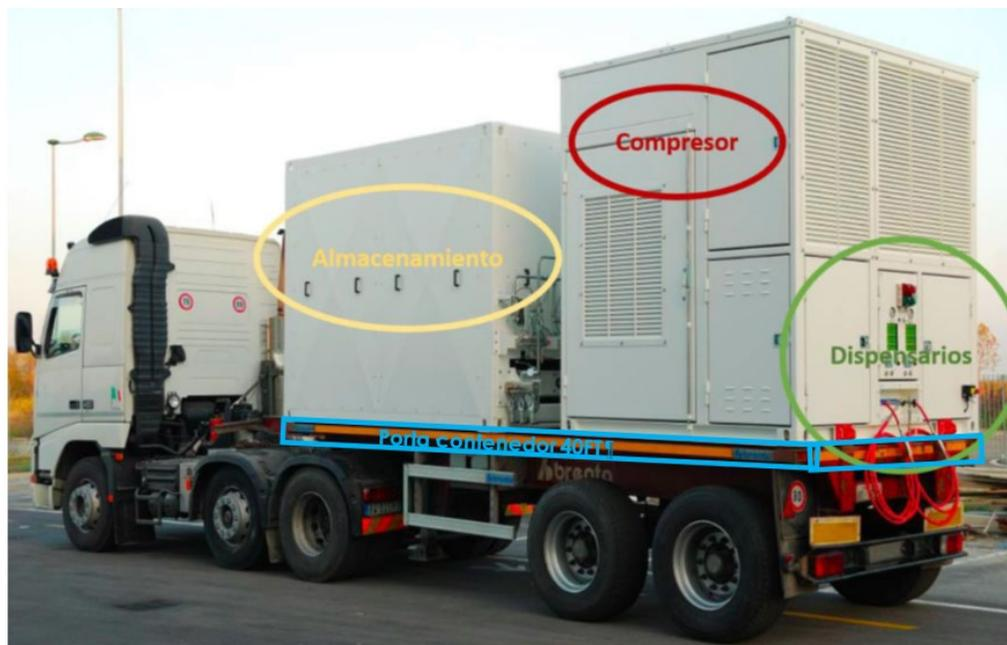
Figura IV-2. Equipos que conforman cada una de las MRU
