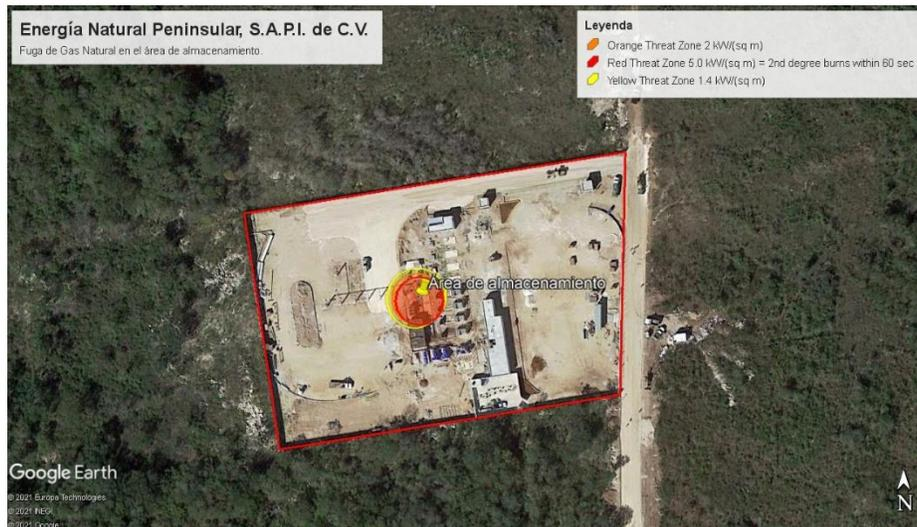
Figura 27. Vista satelital de Escenario 1 – Radiación térmica.
