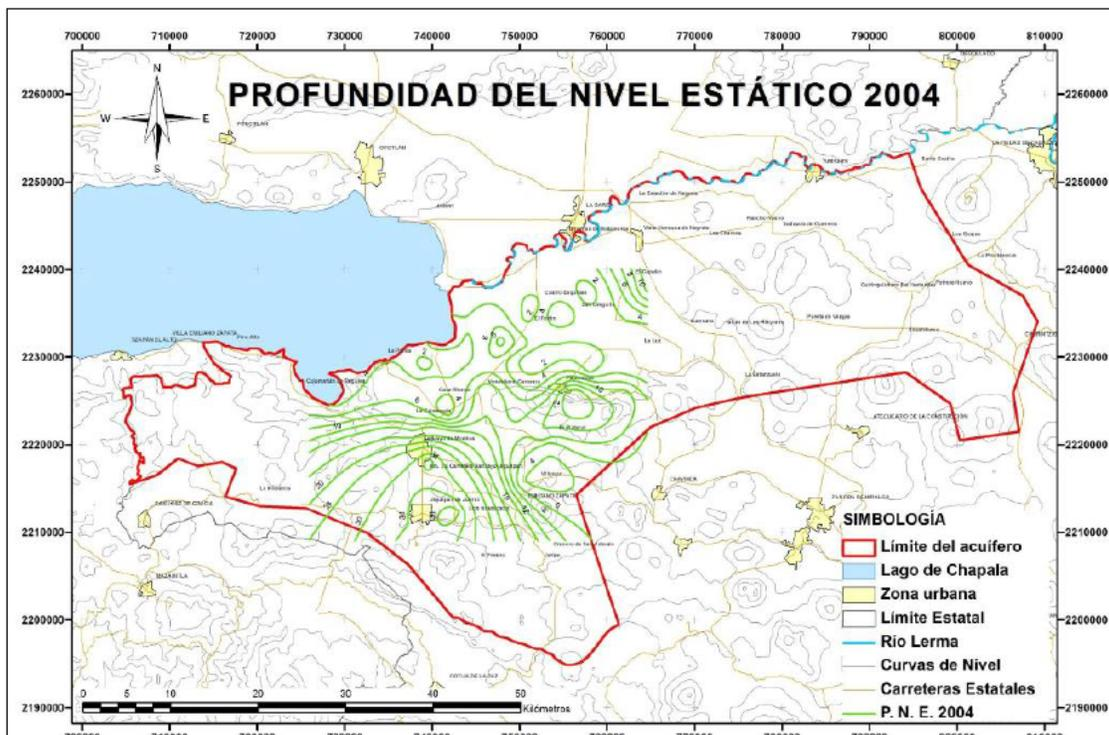
**Figura 1.21** Profundidad al nivel estático (m) correspondiente al acuífero Ciénega Chapala (Zapata, 2010)
