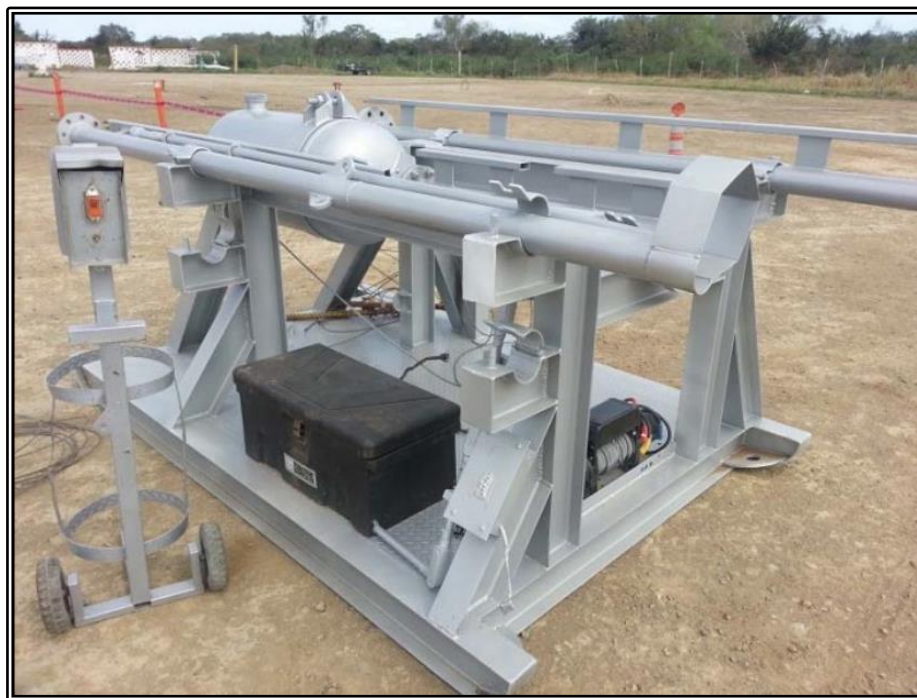
Fotografía III-10.- Fotografía de referencia de quemador vertical antes de instalarse.
