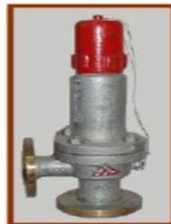
Figura 31 Válvula de Seguridad en PRU.
