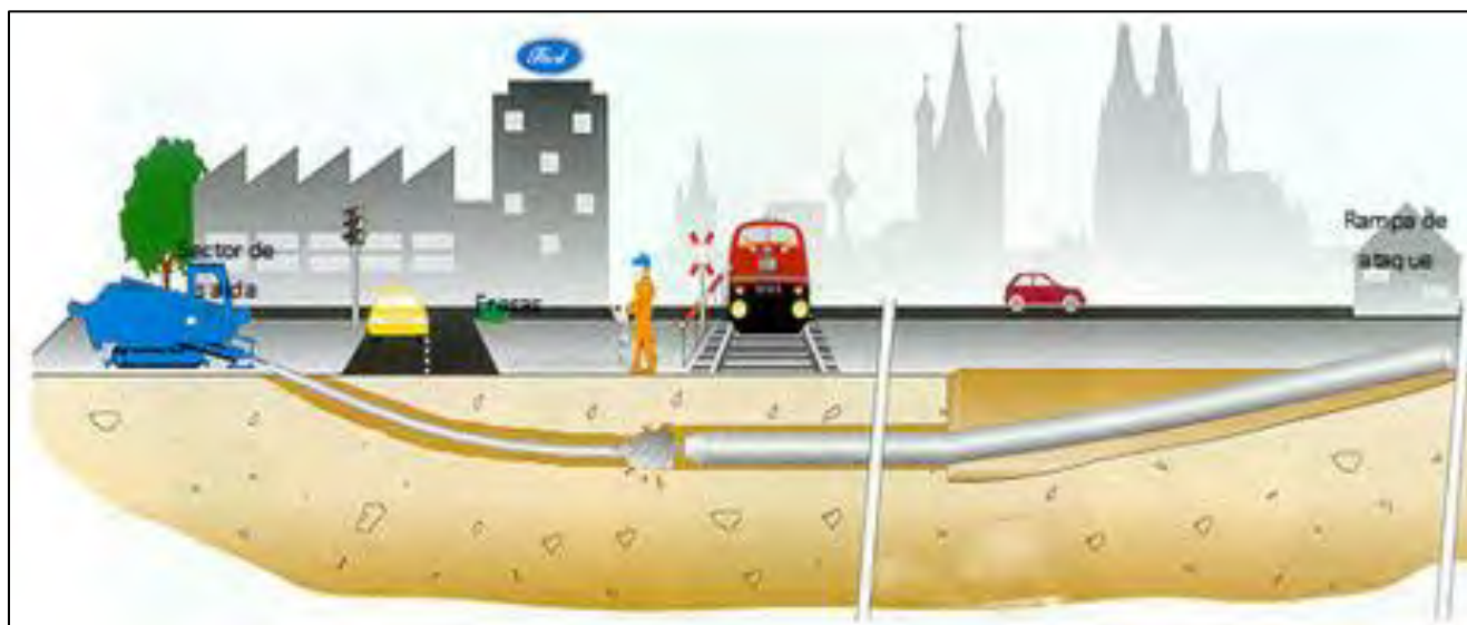
Fig. 2. Técnica de perforación direccional.
