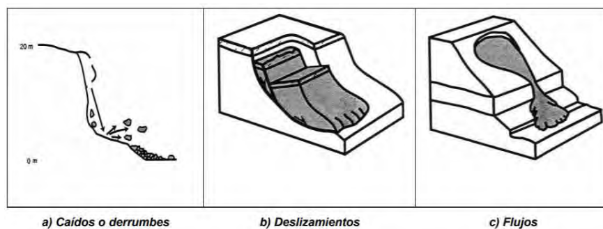
Fig. 36. Movimientos de masa – Deslizamientos
