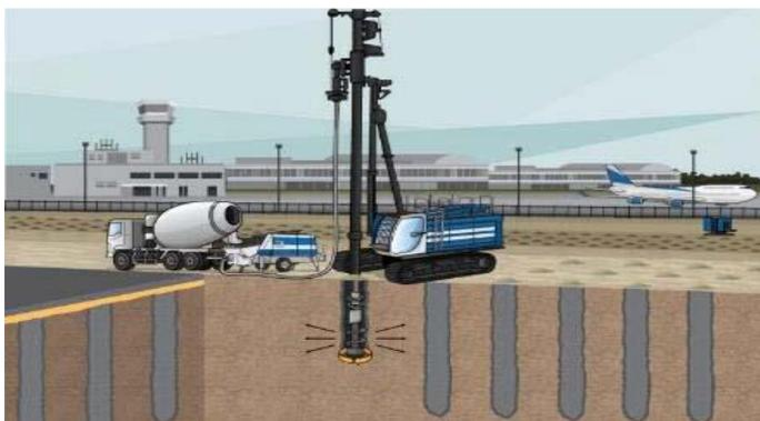
**Figura 3.6 Diagrama de colocación de inclusiones**
