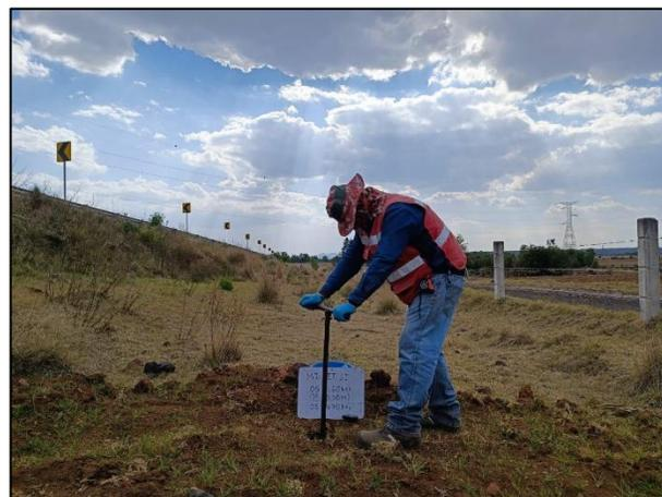
12. Con apoyo del Hand Auger de acero inoxidable se realizó la toma de muestra en la periferia de la Zona Afectada.
