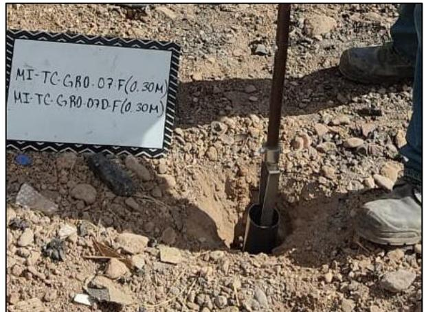
06. Los puntos de muestreo fueron identificados de acuerdo con el plan de muestreo. Toma de muestras dentro de la Fosa de Excavación (Fondo).
