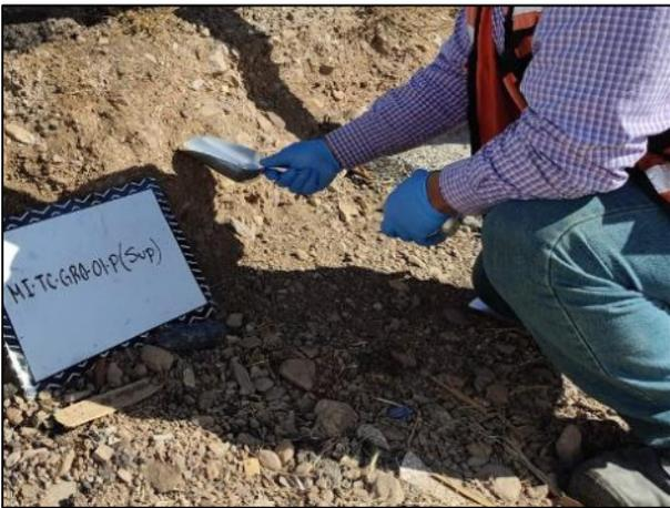
03. Con apoyo de cucharón de acero inoxidable se tomaron las muestras superficiales. Toma de muestras dentro de la Fosa de Excavación (Pared)
