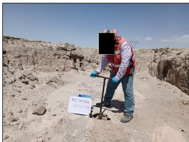
10. Se realizó la toma de muestras de fondo de la Fosa de Excavación (Zona "B").
