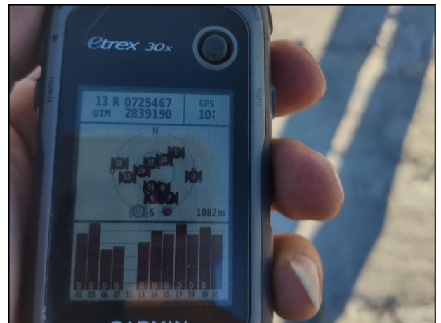
12. Con apoyo de GPS se realizó el levantamiento de coordenadas.
