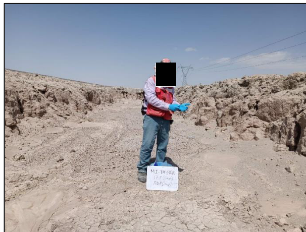
08. Se realizó el cambio de guantes entre cada toma de muestras para evitar la contaminación cruzada de las mismas.
