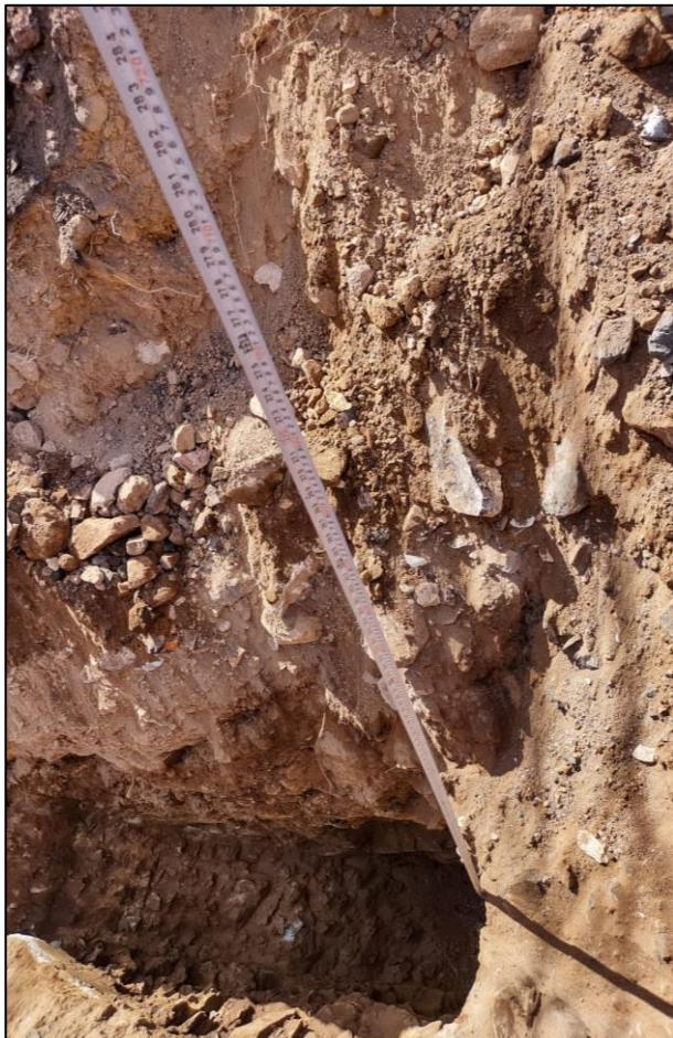
8. Con apoyo de un flexómetro, se tomaron las mediciones correspondientes a la infiltración del Diésel en el Área afectada.
