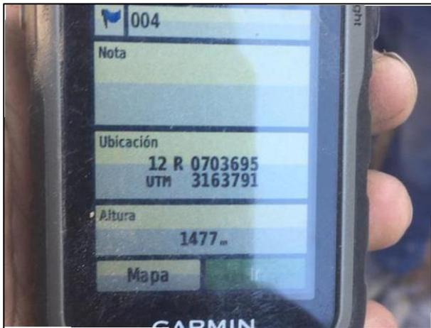
3.- Con apoyo del GPS, se registraron las coordenadas de los puntos de muestreo.
